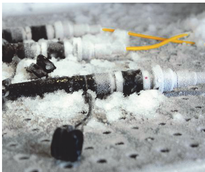
Рис. 2 – Испытания ОС семейства FiberOptic при пониженной рабочей температуре
